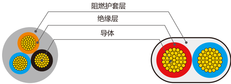
Z(A,B,C)-RVV及60227 IEC 53 (RVV) 结构示意图
