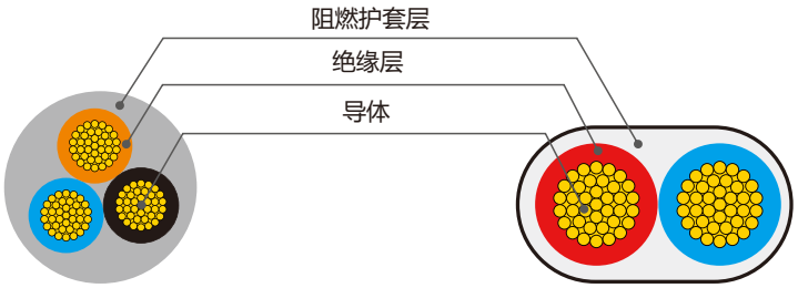
Z(A,B,C)-RVV及60227 IEC 53（RVV）结构示意图
