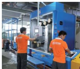
▲ 八头中拉连退火生产线
